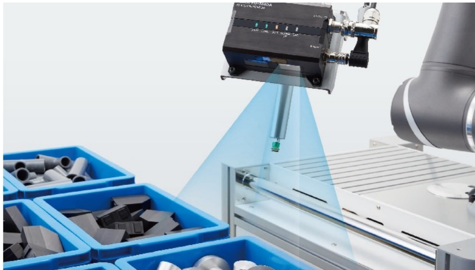
Slika 2-12: Robotski vid pri aplikaciji bin-picking [14]
