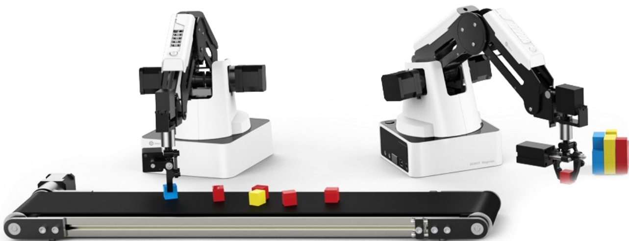
Slika 2-2: 4-osni izobraževalni robot DOBOT MAGICIAN s tekočim trakom [6]
